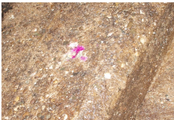
Foto 10: Paarsverkleuring na bespuiten met fenoftaleïne
